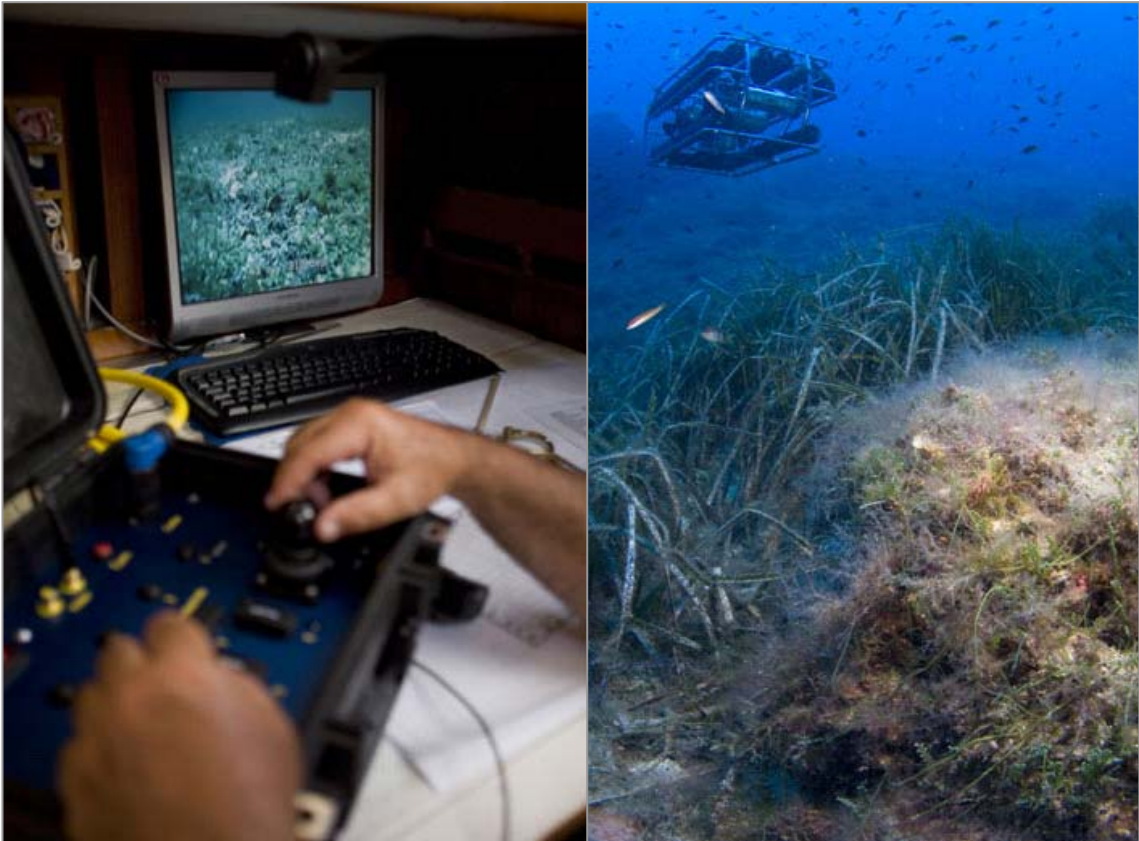
Imagen 19. El Vell Marí está dotado con un ROV (Remote Operated Vehicle) que permite grabar imágenes en las profundidades en las que un submarinista, con una escafandra autónoma, al uso no podría. Desde el barco uno de los técnicos dirige el robot (imagen de la izquierda) mientras desciende y lo orienta hacia las zonas con interés para la exploración. Fotos: Pau Fabregat / CRAM
