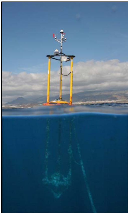
Los sistemas de registro de sonido EARS se han instalado en las boyas oceanográficas existentes entre las islas de Gran Canaria y Tenerife. (Foto: A. Lorente)
