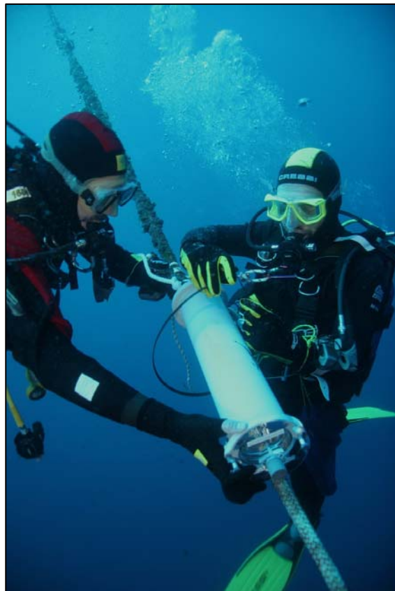
Los sistemas de registro de sonido EARS se han instalado en las boyas oceanográficas existentes entre las islas de Gran Canaria y Tenerife. (Foto: A. Lorente)
